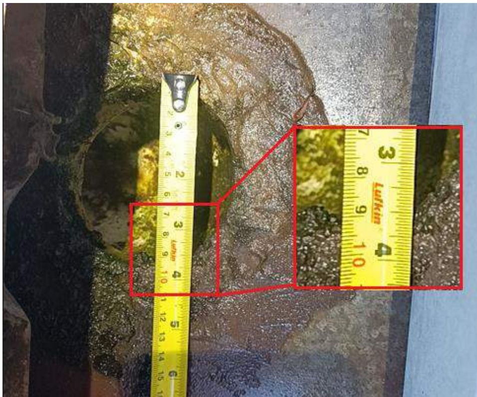
Figura 55 - Medição do diâmetro do bocal de um dos condutores
